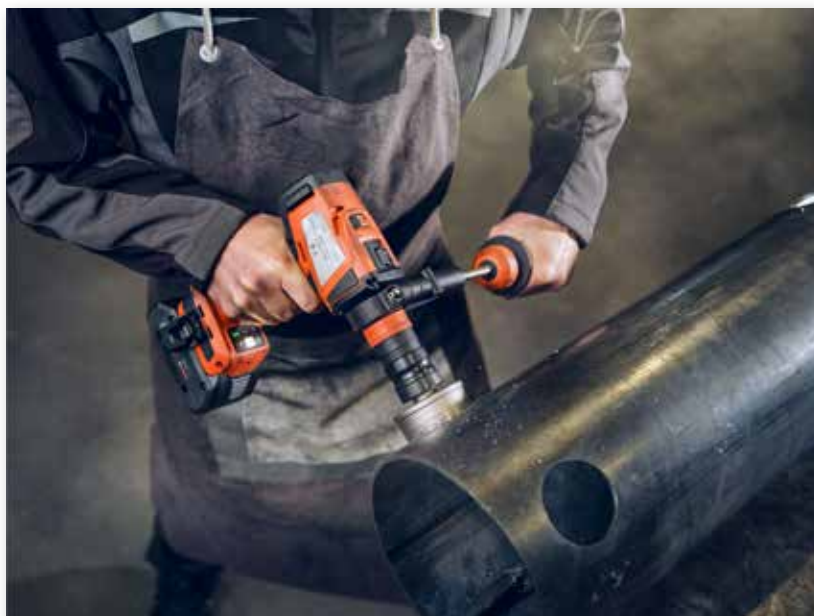
Lyukfúrés adapter nagy furatok fúrásához fémekben. Kompatibilis minden QuickIN/QuickIN MAX szerszámcsatlakozóval rendelkező FEIN akkus csavarozóval.
