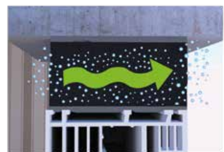
A páratartalom függvényében változó páraáteresztő képességű fólia lehetővé teszi a pára távozását a fugából. Ennek iránya mindig a külső és belső hőmérsékletkülönbség függvénye. Ez a működési elv teljesíti a RAL-ban meghatározott ajánlásokat. A fuga tartósan száraz marad és kiváló hőszigetelést biztosít.
