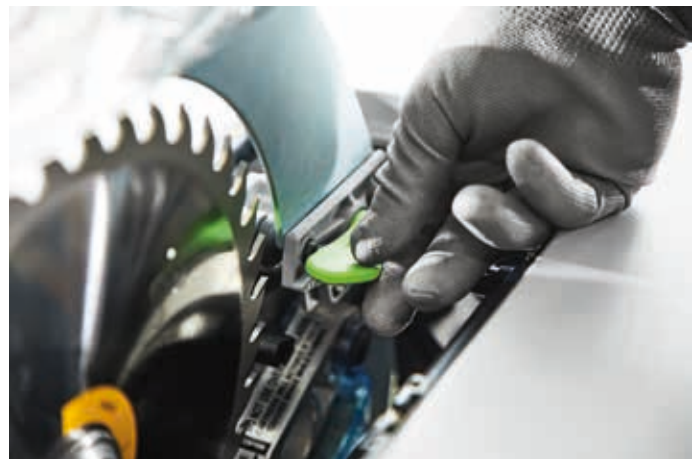
Az intelligens patron kioldja az előfeszített rugót, és egy alumínium blokkolót lő a fűrészlapba. Kioldás után a patron néhány mozdulattal kicserélhető.
