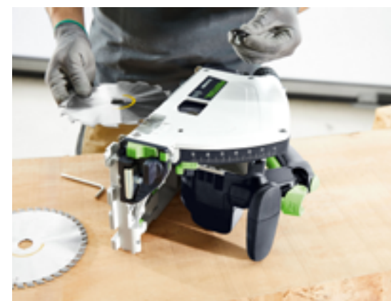
A fűrészlapcseréje még kényelmesebb: Az átgondolt kialakítás lehetővé teszi a fűrész oldalára történő helyezését, így egyszerűsíti a fűrészlapcserét. Emellett a szorítókarima formázására a fűrészlap nem akad el.
