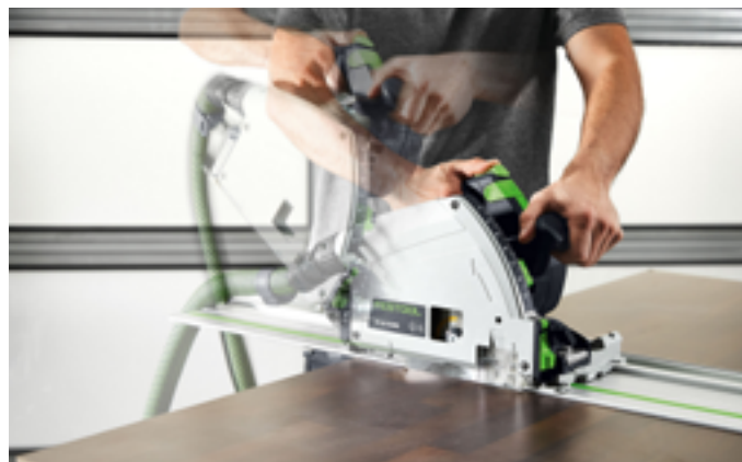
A KickbackStop funkció csökkenti a visszarúgás miatti sérülésveszélyt fűrészelés során, illetve a munkadarabba való bemerítéskor. Az aktiválódást követően a fűrész azonnal ismét használatra kész – csere és kiegészítő költségek nélkül.
