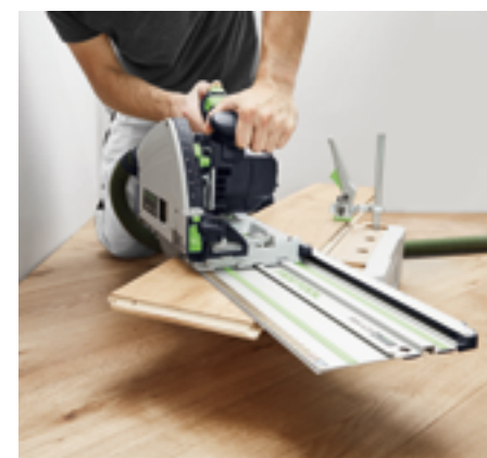
Maximális sokoldalúság: A bevált vezetősín mellett az új TS 60 K merülőfűrész minden FSK keresztvágáshoz készült vezetősínhez is csatlakoztatható, így gyors, mobil és szögprecíz leszabást tesz lehetővé.
