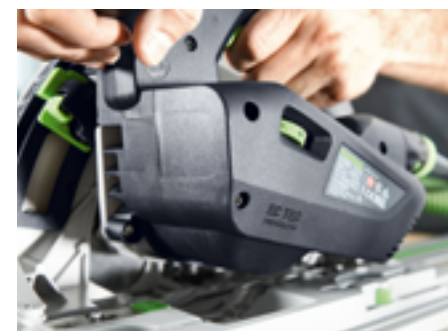
A szénkefe nélküli EC-TEC motor révén az új TS 60 K gyakorlatilag karbantartásmentes és különösen nagy teljesítményű.
