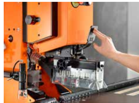
A fúrószárral és (színesen jelölt) matricával ellátott fúrófej (opcionális) gyorsan és szerszámok nélkül rögzíthető egy feszítőkar segítségével.
