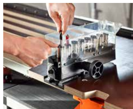
A fúrószárral és (színesen jelölt) matricával ellátott fúrófej (opcionális) gyorsan és szerszámok nélkül rögzíthető egy feszítőkar segítségével.
