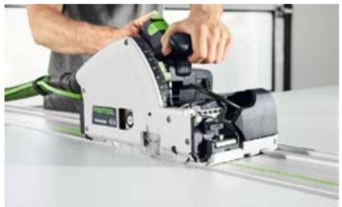
A beépített elővágó egység mindkét oldalon kipattogzásmentes vágást biztosít már az első vágásnál. Így a vágott él közvetlenül készen áll a további megmunkálásra.
