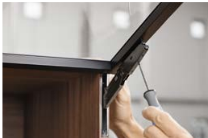
3-dimenziós állítási lehetőség: A torx-csavarok segítségével 3-dimenzióban beállíthatja az előlapot – a harmonikus fugaképpért.
