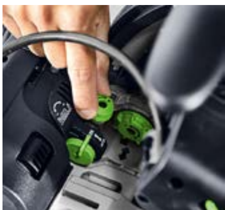
Az elővágó egység nyomvonalának és mélységének beállítása: Az elővágó fűrészlap pontosan beállítható a kipattogzásmentes vágott élért.
